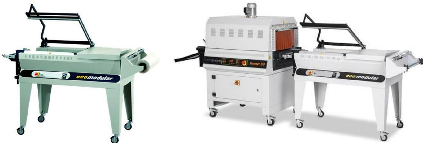
Схема 1 – Полуавтоматический упаковщик с Г-образным ножом, модель ECOMODULAR
