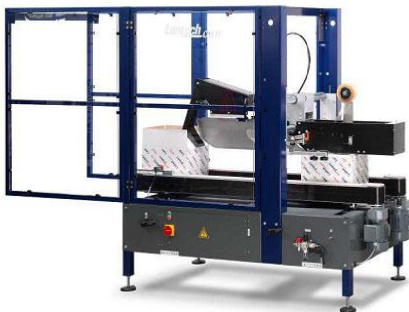
Показан заклещик с левым выходом продукции
