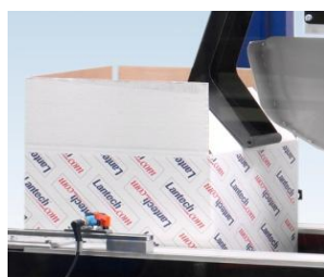
Предварительное сгибание коротких клапанов
